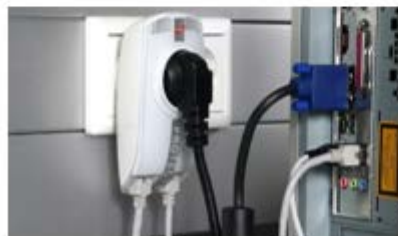
16. ábra: Számítógép túlfeszültség-védelme
