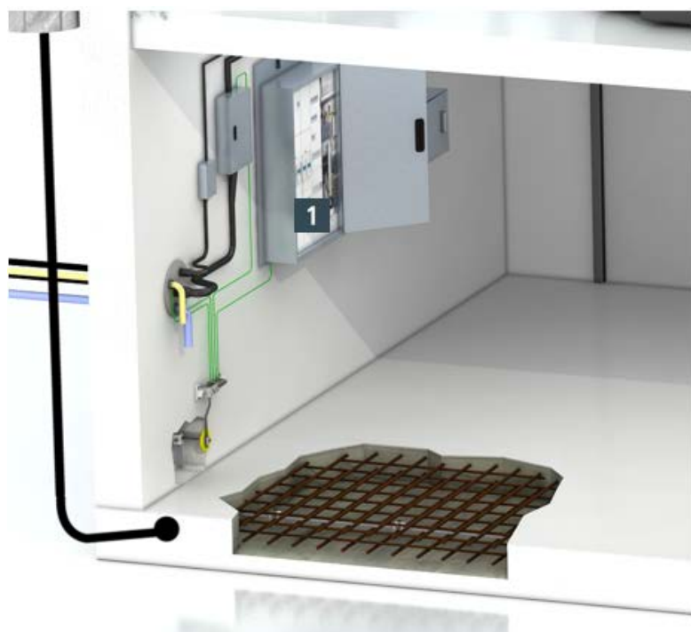
5. ábra: 1.+2. típusú kombinált villámáram-levezető telepítése a főelosztó szekrényben
