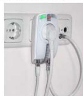
15. ábra: TV, videó, multimédia túlfeszültség-védelme családi házak esetén
